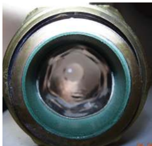
Tube de contrôle monté sur l'eau chaude après 24 mois de traitement avec le système Aqua4D®.
